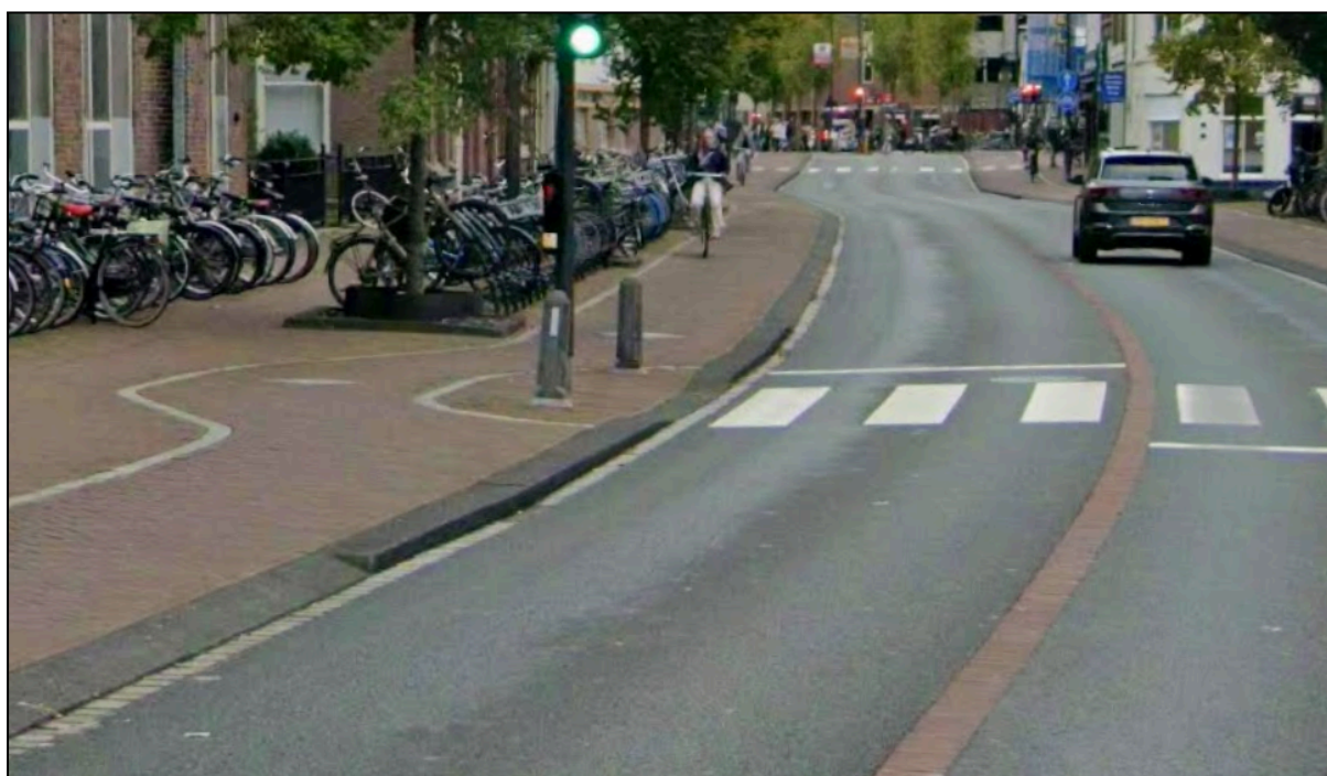
Figuur 46: uitbuigen fietspad met krappe boogstraal ter hoogte obstakels Hooigracht (voorbeeld)
